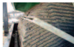
Kolonije bakterija na biološkoj opni biorotora
