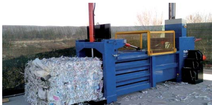
Horizontal baling press HPB-25
